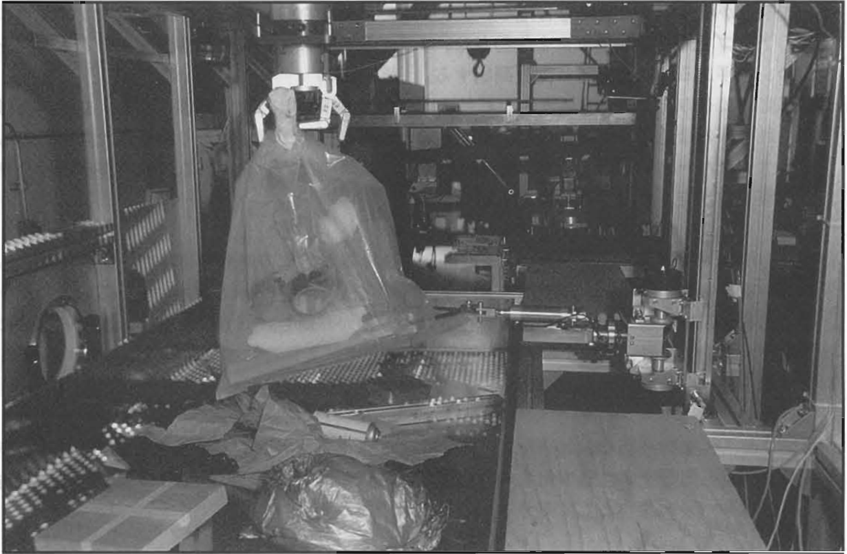
図1 Zマストの先端に取り付けられたグリッパーが模擬廃棄物のバッグの位置を決め、空気作動のはさみがバッグの底を切断して分別台の上に中身を出す準備をしている。
